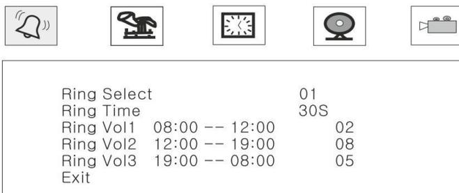
Для навигации по разделам меню используется прокрутка кнопки-колесика, а для входа в нужный раздел следует нажать на неё. Находясь в выбранном разделе, выбор нужного параметра осуществляется нажатием на кнопку-колесико, а регулировка значений - прокруткой.
