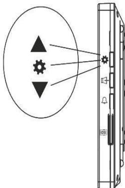
Кнопка-колесико, расположенная на боковой части монитора AVD-709 (AVD-709M) имеет следующие функции:
