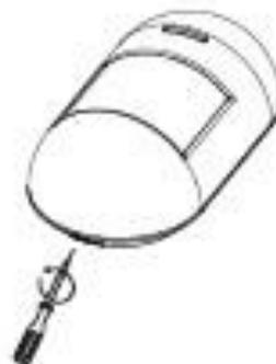
(2) Выверните винт при помощи отвертки.
